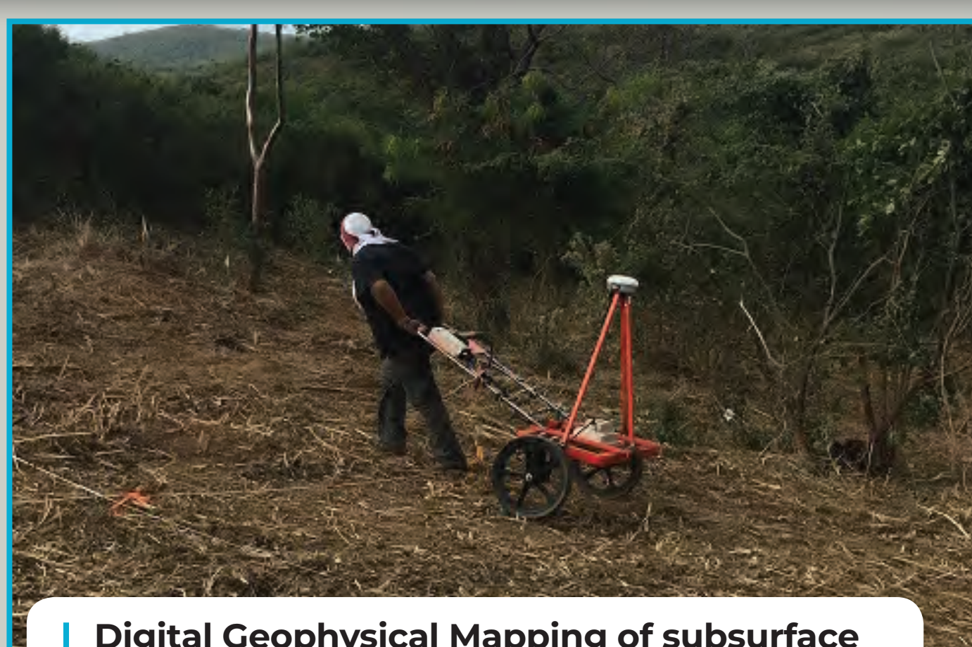
Digital Geophysical Mapping of subsurface anomalies at UXO 13 Cartografía geofísica digital de anomalías debajo de la superficie en UXO 13
