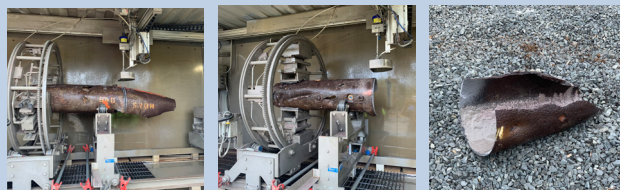
Water jet cutting an inert munition Sistema de corte por chorro de agua cortando una munición inerte
