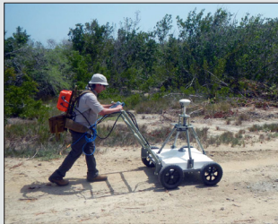
» Geophysical classification equipment used to characterize subsurface anomalies Equipo de clasificación geofísica utilizado para caracterizar anomalías del subsuelo
