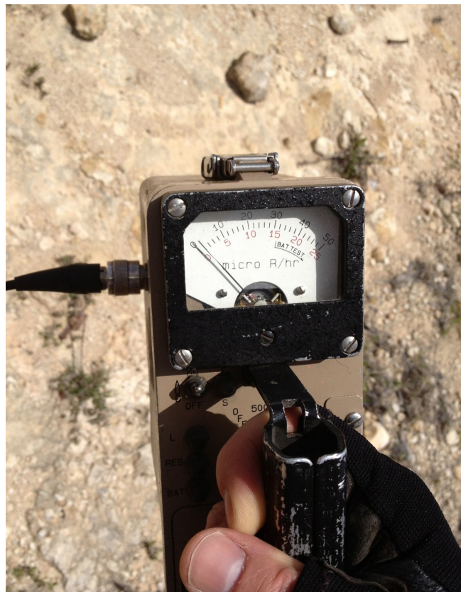
Ludlum Modelo 19 con una sonda de yoduro de sodio de 1" por 1"
