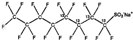
MOLECULAR FORMULA: <sup>13</sup>C<sub>4</sub><sup>12</sup>C<sub>4</sub>F<sub>11</sub>SO<sub>3</sub>Na      MOLECULAR WEIGHT: 526.08
